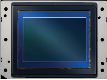
↑ De fullframe-sensor van de Nikon D850 telt ruim 45 megapixels.
